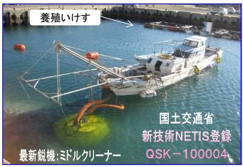
除去率82%!赤潮対策に威力を発揮! 赤潮の原因であるシャットネラのシスト(休眠細胞)の除去 汚濁防止膜撤去前の堆積物の除去にも最適! 養殖場の横での浚渫にも問題なくOK! 除去率88%!ため池のセシウム除去!
